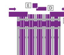
**4** Assembler les lisses de finition **C** en utilisant le manchon de jonction **D**. En fonction du système de fixation (Poteau), vous utiliserez ou non, la pièce **E**. Venir ensuite emboîter la lisse sur la partie supérieure du panneau.
